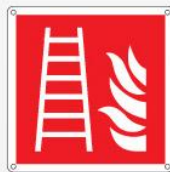
Scala antincendio F003
